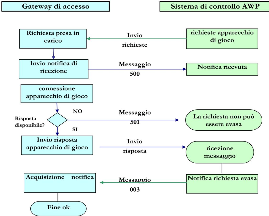
Figura 4 : Flusso di comunicazione delle richieste tramite il gateway di accesso
